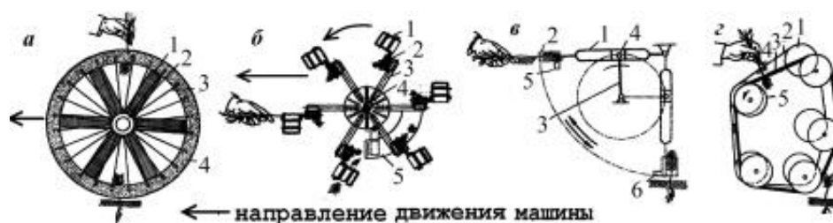
Рис. 17. Типы посадочных аппаратов лесопосадочных машин: а) – дисковый аппарат: 1 – жесткий вырезной диск; 2 – ступица; 3 – пружинящие спицы; 4 – гибкий кольцевой захват; б) – лучевой посадочный аппарат: 1 – щеки захвата; 2 – корпус захвата; 3 – держатель; 4 – съемное крепление захвата к диску; 5 – раскрыватель захватов; в) – посадочный аппарат с качающимся захватом: 1 – рычаг; 2 – захват двухстворчатый; 3 – кривошип; 4 – ползун; 5 – верхний упор для открывания створок; 6 – нижний упор для раскрывания; г) – ременный, или ленточный, посадочный аппарат: 1 – направляющий шкив; 2 – ремень (лента); 3 – плоский ремень; 4 – эластичная шагообразующая подушка; 5 – направляющий шкив
