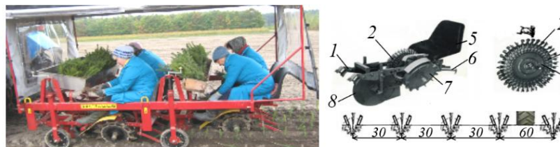
Рис. 20. Школьная лесопосадочная машина Л-218: 1 – рама посадочной секции; 2 – посадочный аппарат; 3 – обод с 36 захватами; 4 – ступица посадочного аппарата; 5 – сиденье сажальщика; 6 – загортач-выравниватель; 7 – приводное колесо; 8 – комбинированный дисково-коробчатый сошник
