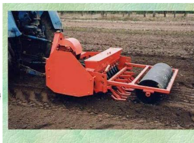
Рис. 11. Сеялка СЛН-5/9: 1 – звено автосцепки; 2 – ограничитель; 3 – шарнир; 4 – рама, 5 – бороздообразующие катки тяги; 6 – бункер для семян; 7 – цепная передача; 8 – семяпровод; 9 – загортаци; 10 – прикатывающий каток
