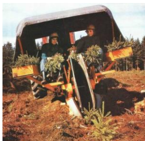
Рис. 28. Лесопосадочная машина МЛК-1: 1 – рама; 2 – кабина; 3 – сиденье; 4 – дисковый посадочный аппарат; 5 – прикатывающие катки; 6 – сошник;
