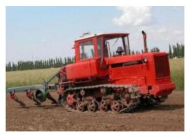
Перед тем, как завести трактор и тронуть его с места, нужно удостовериться в отсутствии посторонних предметов, что могут быть зажаты между звеньями гусениц. Одновременно с тем следует закрыть боковины капота. Когда температура воды, содержащейся в системе охлаждения, достигнет 75 °C, необходимо приоткрыть шторку радиатора.
